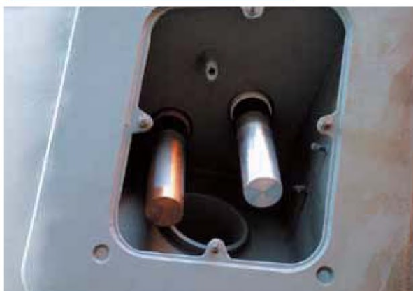
シーチェストに電極をダイレクトに装置した安価なタイプ
